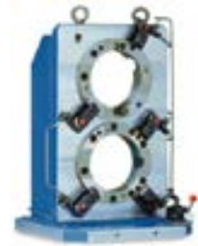
横型M/C用フランジ加工油圧治具
