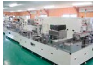
一般針（注射針）全自動組立装置
