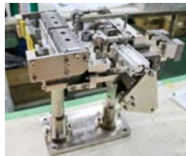
機械加工後の部分アッセンブリ (設備や作業)
