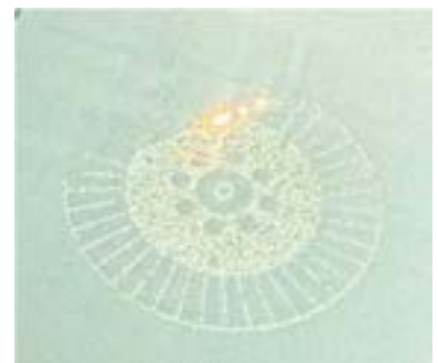
金属3Dプリンタ（L-PBF）での造形
