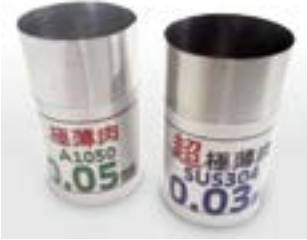
最大薄さ0.03mmを切削対応
