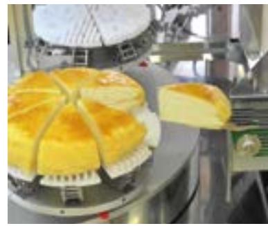
丸ケーキ超音波切断装置
