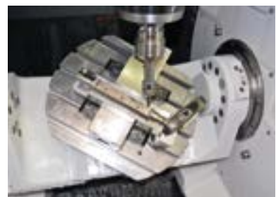
5軸MCにより高精度位置出し
