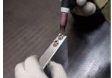
ガス流路部品溶接
