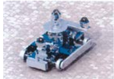
原子炉プール向け 水中ロボット
