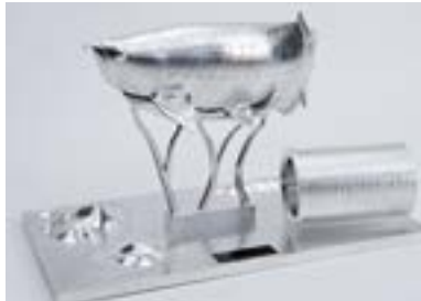
写真→モデリング→CAM→切削加工
