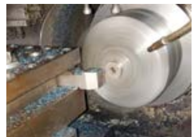
ピニオン歯車 旋削状況 (ワイパー部品)
