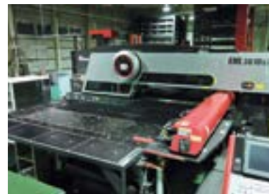
写真① パンチ・レーザ複合加工機
