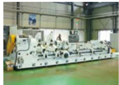
BTA方式 深孔加工機
