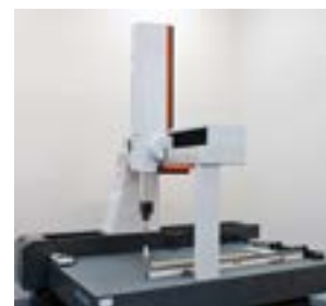
CNC三次元測定機 X900 Y1600 Z500
