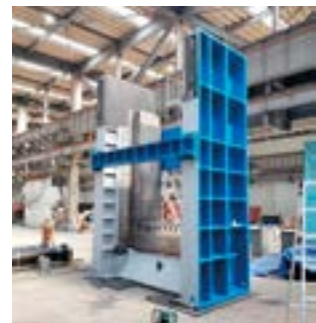
スクラップ切断機総重量約40 t
