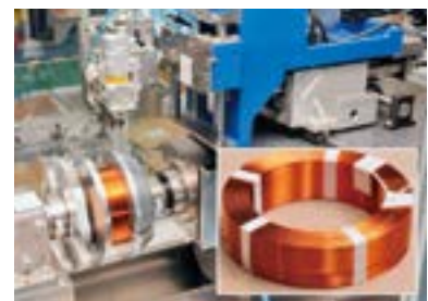
多層巻き完全整列自動巻線機
