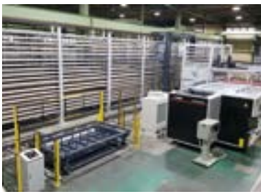
ファイバーレーザー8kwにマーキング装置連動自動倉庫122棚(366トン格納)24時間稼働
