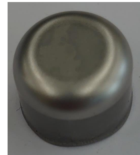
図3深絞りプレス加工試作品（内径φ18/外径19×15mmH）
