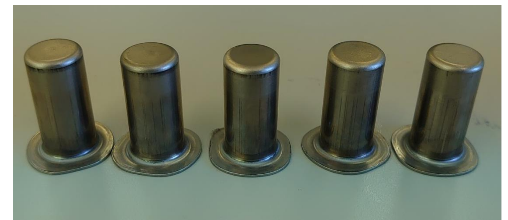
図3 深絞りプレス加工試作品 (φ16×34mmH)
